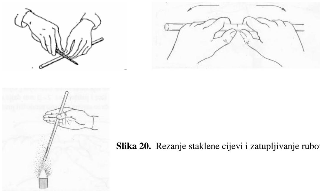
**Slika 20.** Rezanje staklene cijevi i zatupljivanje rubova
