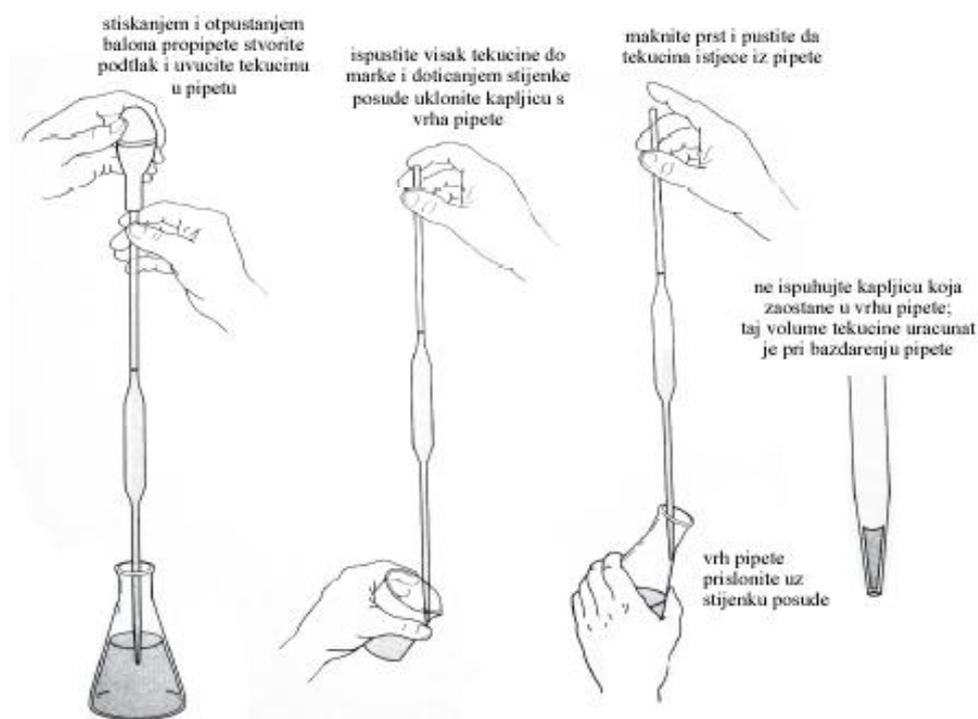
Slika 58. Postupak pipetiranja
