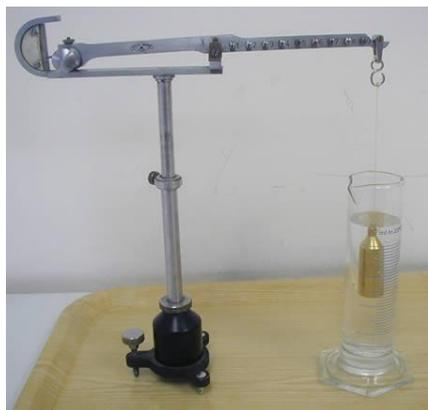
*Mohr-westphalova vaga* se koristi za određivanje relativne gustoće tekućina. Vaga se sastoji od dva kraka, kraćeg i duljeg. Na duljem kraku je obješen stakleni valjak. Kada se nalaze na zraku oba kraka su u ravnoteži. Kada se stakleni valjak uroni u tekućinu poremeti se ravnoteža, a ponovo je uspostavljamo opterećivanjem drugog kraka utezima. Iz mase dodanih utega očitamo gustoću tekućine
