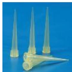
**Slika 59.** Mikropipete i nastavci za mikropipete
