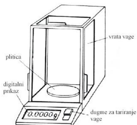
*Analitička vaga* je osjetljiv i skup instrument za precizno određivanje mase tvari. O njezinoj ispravnosti i preciznosti ovisi točnost rezultata analize. Mjeri stočnošću 0,0001 g ( $\pm$  0,1 mg). Najrašireniji tip analitičke vage je vaga kapaciteta ispod 300 g, točnosti očitavanja 0,1 mg. Zatvorena je u staklenom ormariću koji ima mogućnost otvaranja s prijeda i s bočnih strana. Ormarić štiti vagu od prašine i zračnih strujanja.
